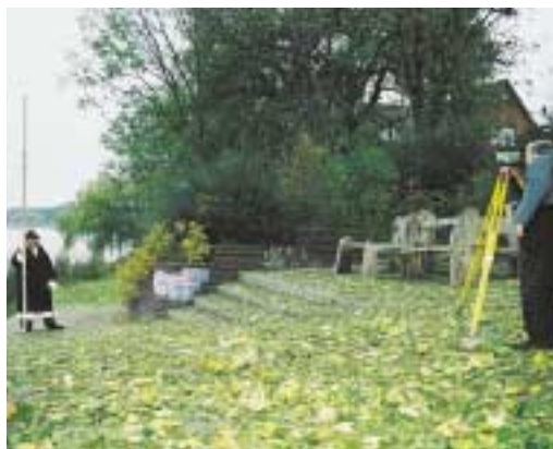
Messung der Neigung des Weser-Fernradwegs an einer T-Kreuzung.
